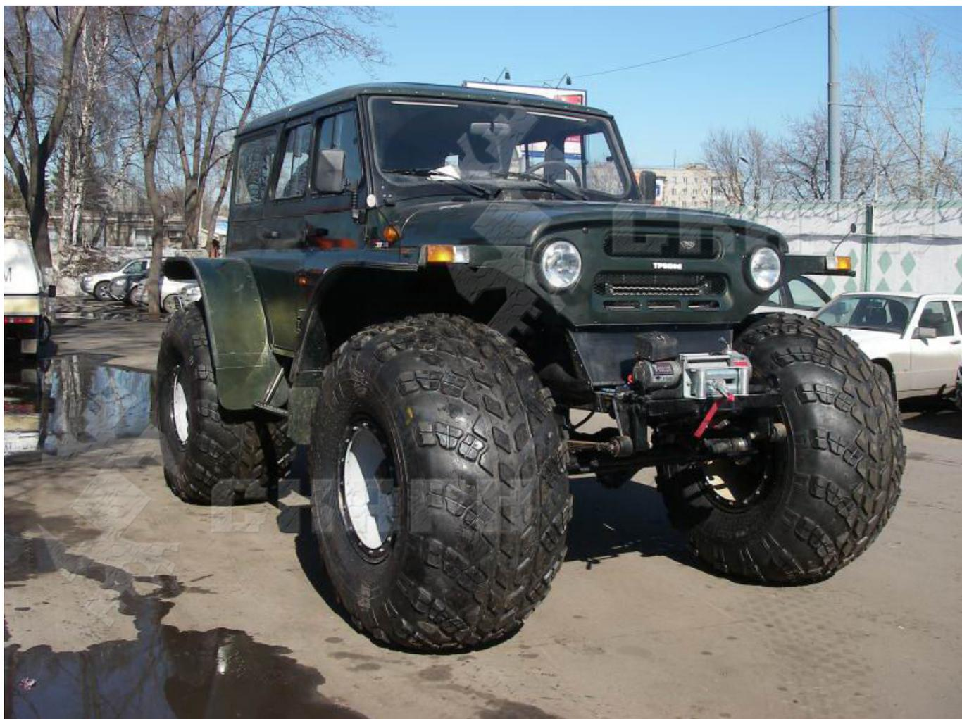
Проверенный временем УАЗик, хорош сам по себе, а уж для машины, оборудованной фирменными бескамерными шинами сверхнизкого давления марки ТРЭКОЛ вкпе с полным приводом, централизованной подкачкой колёс, лебёдкой, блокировками дифференциала, внушительным клиренсом, и вовсе не будет преград в условиях полного бездорожья! Для России с её огромными просторами — это отличное решение!
