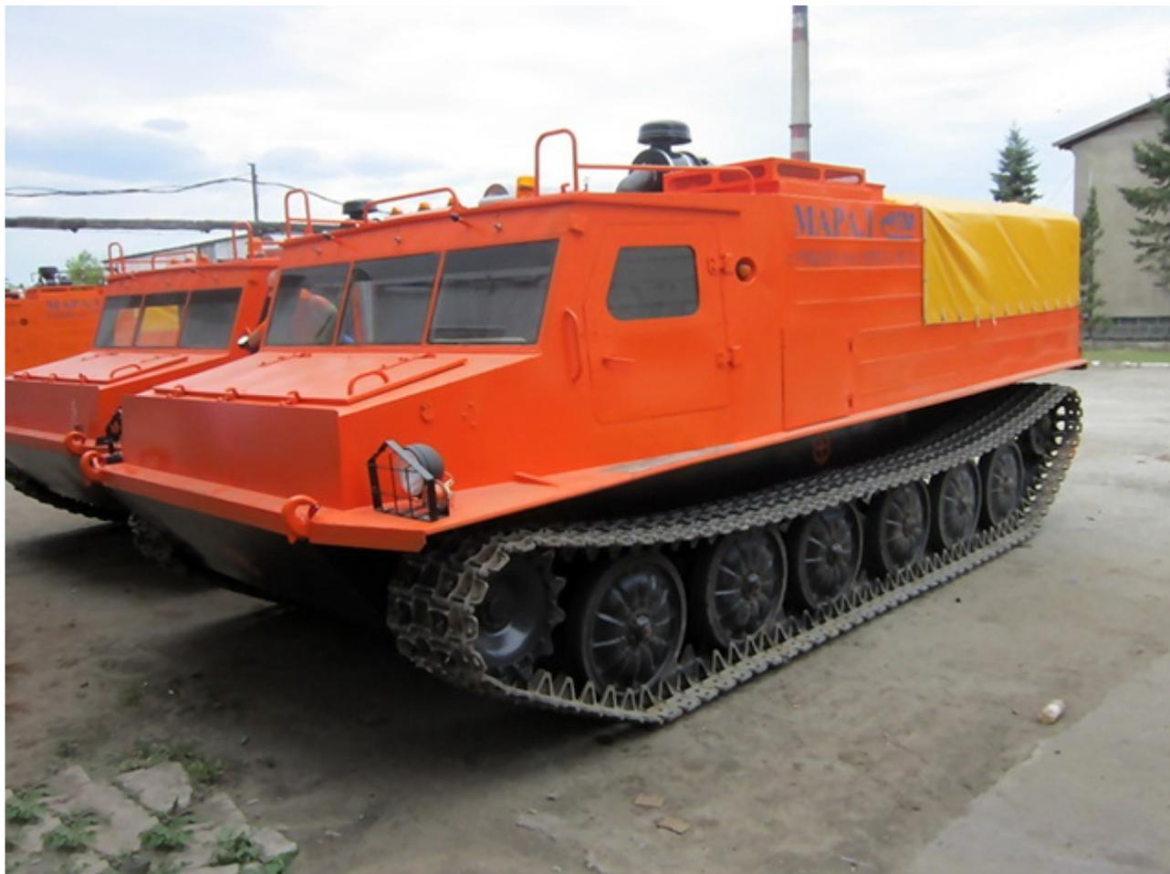
ГТ-ТР оборудован грузопассажирским кузовом со съёмным тентом и предназначен для перевозки людей и различных грузов по бездорожью в условиях заснеженной целины и лесисто-болотистой местности при температурах воздуха от минус 45 до плюс 45°С.
